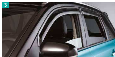
3| Защитные дефлекторы от дождя и ветра. Комплект 2 шт. Передние. 990E0-54P24-000 Задние. 990E0-54P25-000
