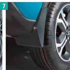
7| Брызговики жесткие. 6 Могут быть окрашены в цвет кузова. Передние. 72210-54P00-000 Задние. 72230-54P00-000
